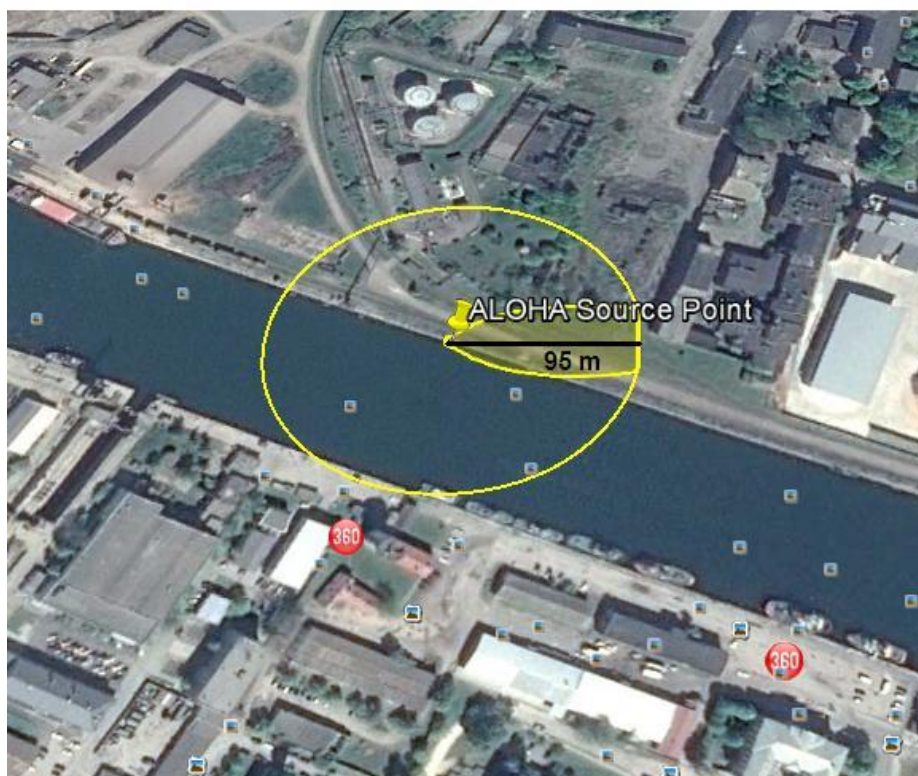
24.attēls. Lokanā cauruļvada plīsums benzola pārsūkņēšanas laikā uz tankkuģi ar benzola noplūdi un tvaiku toksisko koncentrāciju izplatību
