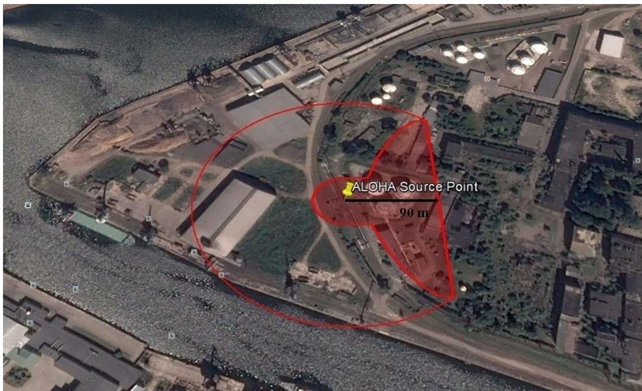
20.attēls. Vagoncisternas sabrukums dzelzceļa estakādē ar benzola noplūdi un tvaiku – gaisa maisījuma sprādzienbīstamo koncentrāciju izplatību
