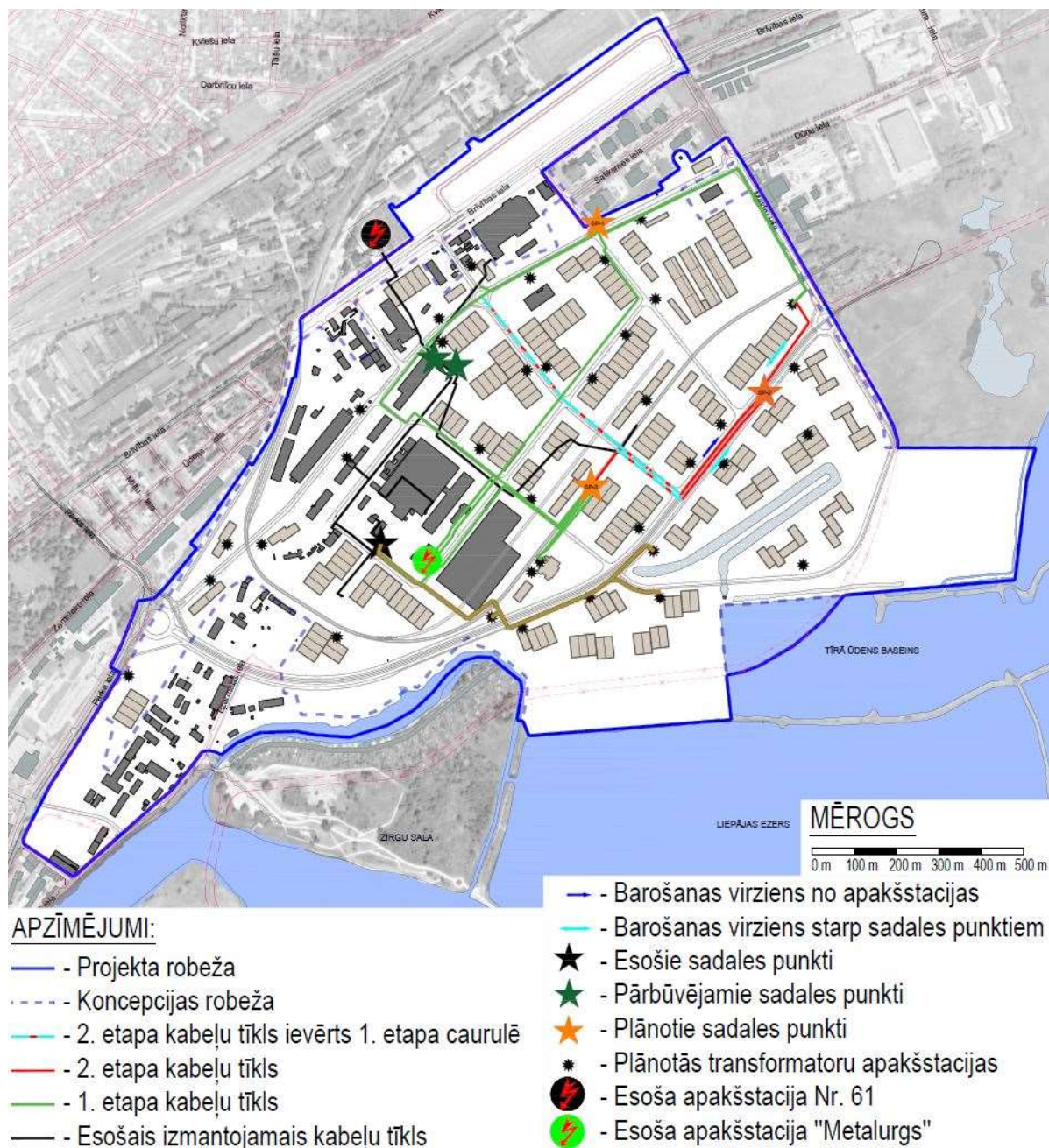
47. attēls. Plānotās elektroapgādes tīklu shēma. 2.variants, 2. posms
