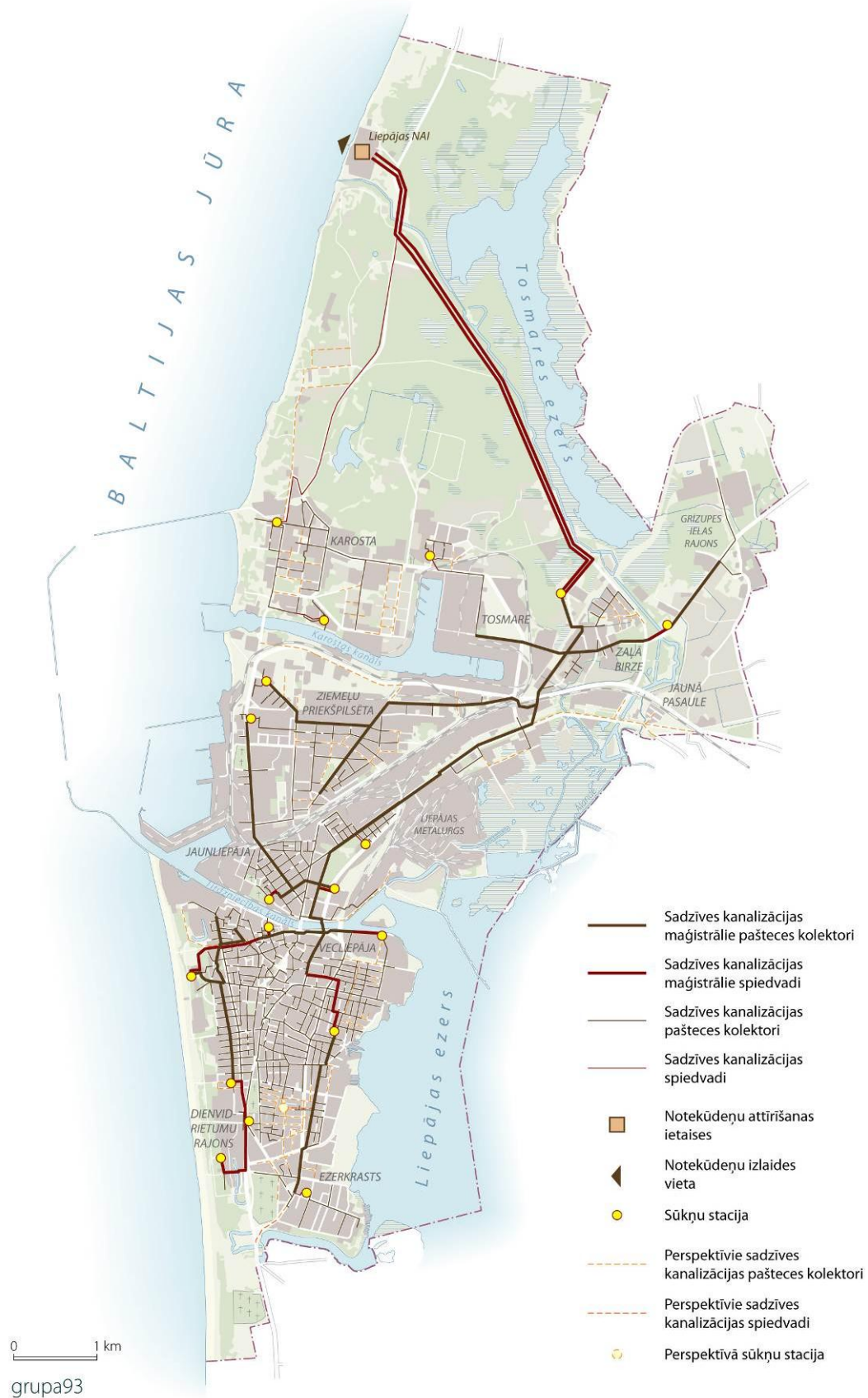
27.att. Sadzīves kanalizācijas apgāde
