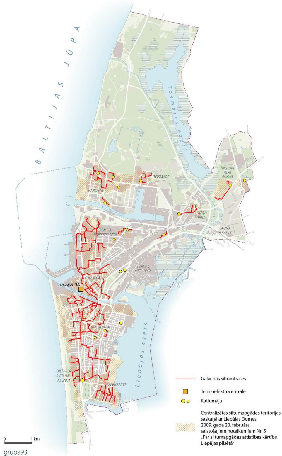
32.att. Centralizētā siltumapgāde
