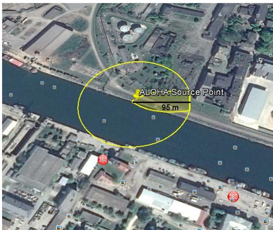
8. attēls. Lokanā cauruļvada plīsums benzola pārsūknēšanas laikā uz tankkuģi ar benzola noplūdi un tvaiku toksisko koncentrāciju izplatību
