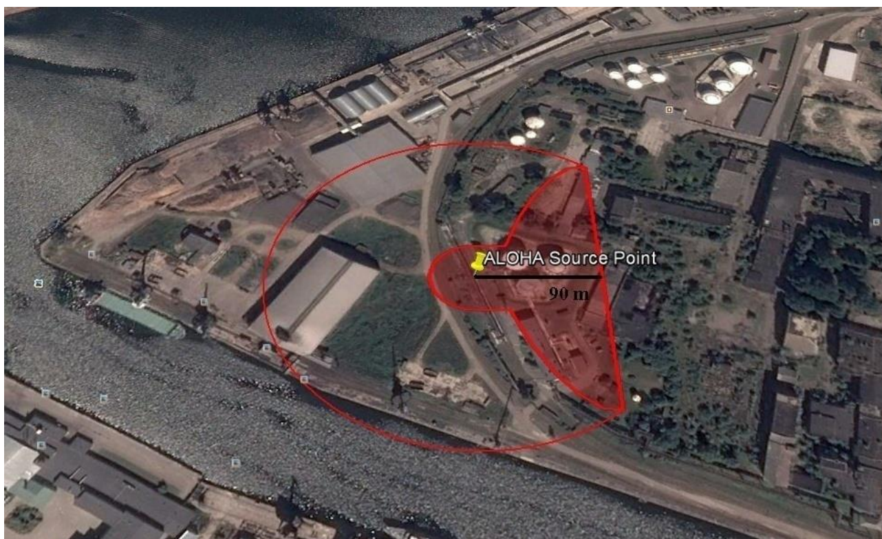
6.attēls. Vagoncisternas sabrukums dzelzceļa estakāde ar benzola noplūdi un tvaiku – gaisa maisījuma sprādzienbīstamo koncentrāciju izplatību
