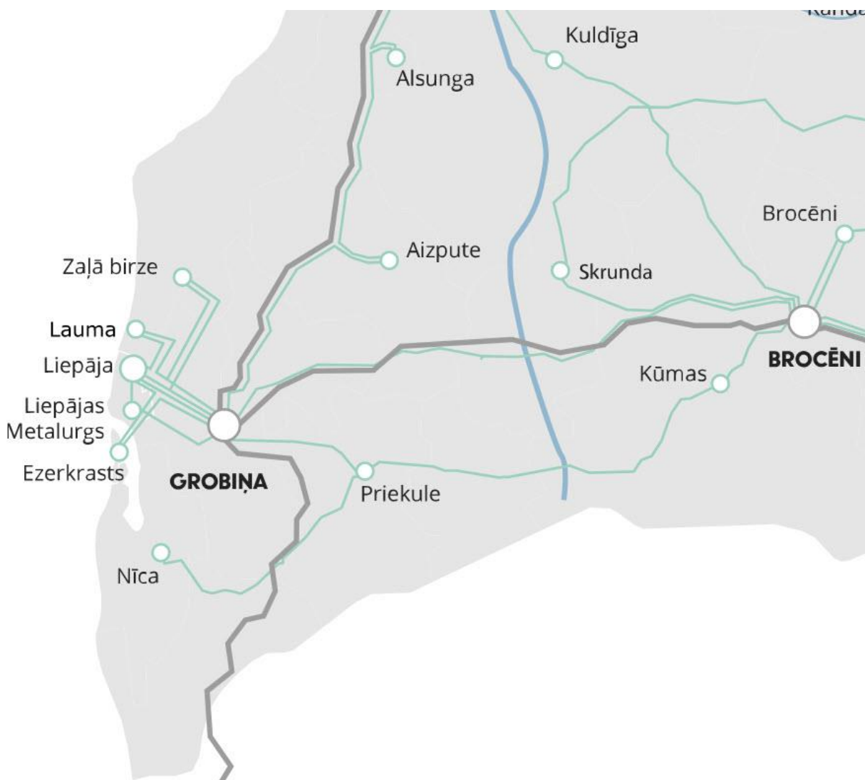
48. attēls. 330 kV un 110 kV elektrisko tīklu shēma Kurzemē [AS "Augstsprieguma tīkli"]
