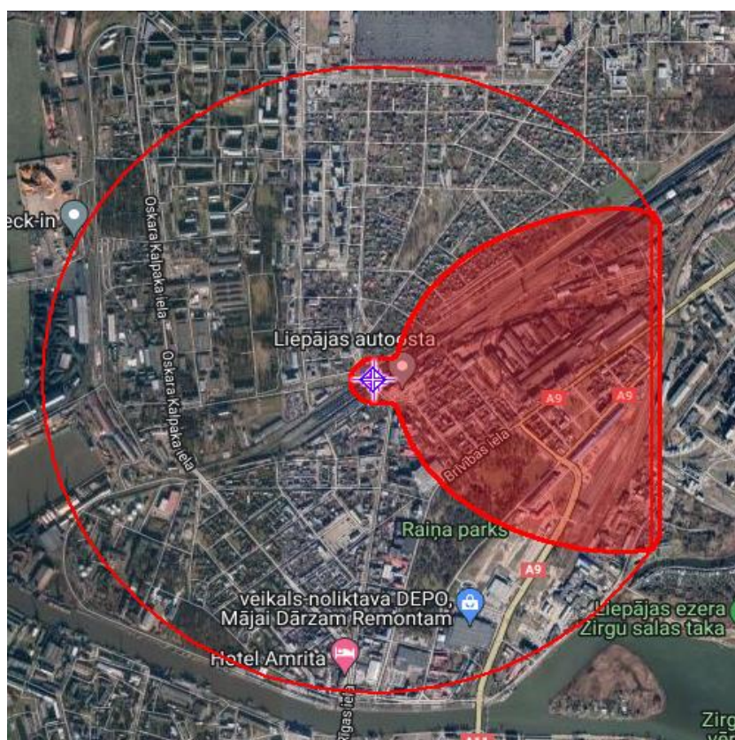
67. attēls. Benzīna noplūdes no vagoncisternas toksisko tvaiku izplatība
