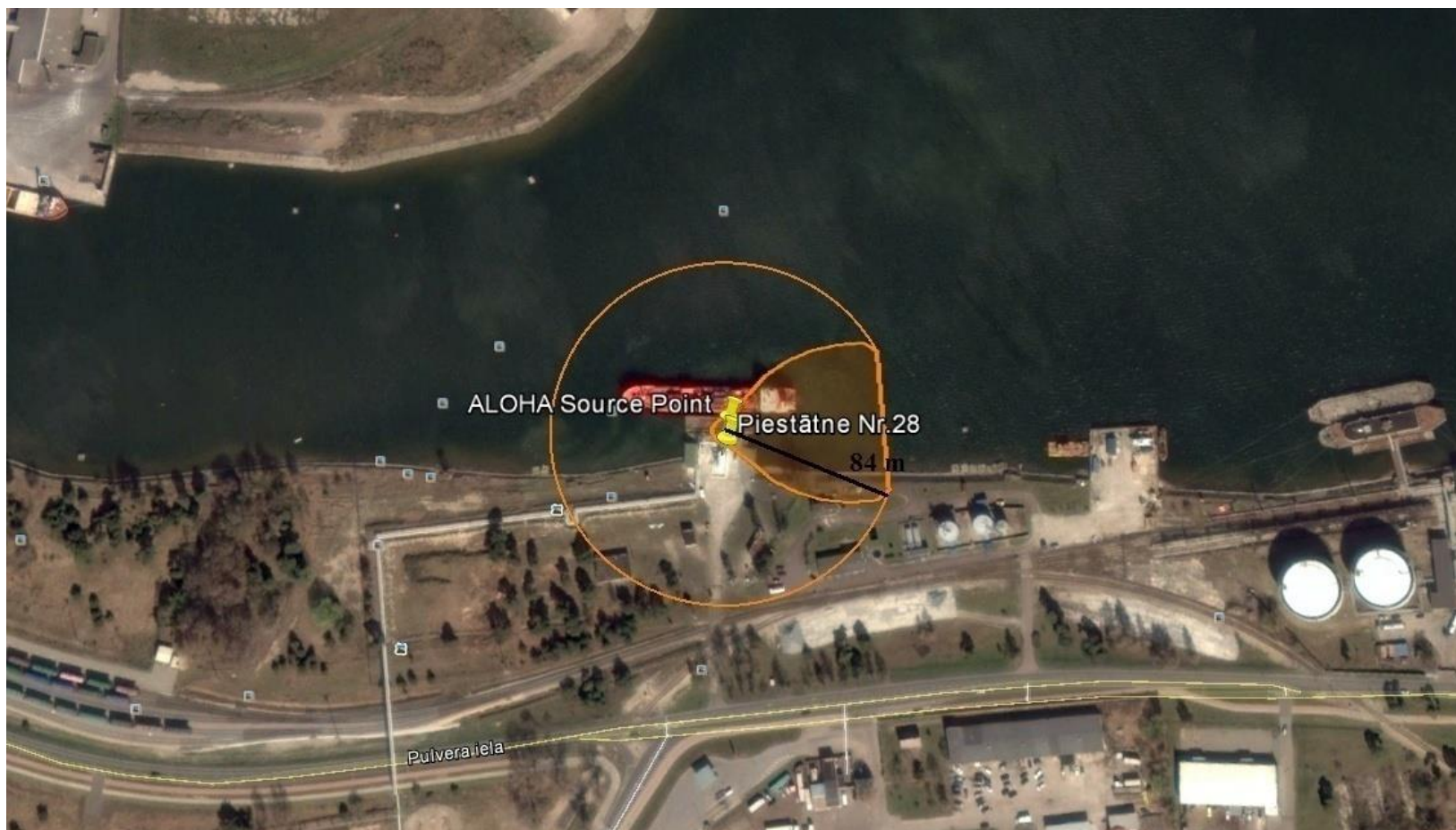
25. attēls. Lokanā cauruļvada plīsums/atvienošanās benzīna pārsūkņēšanas laikā uz/no tankkuģi ar benzīna noplūdi un tvaiku toksisko koncentrāciju izplatību
