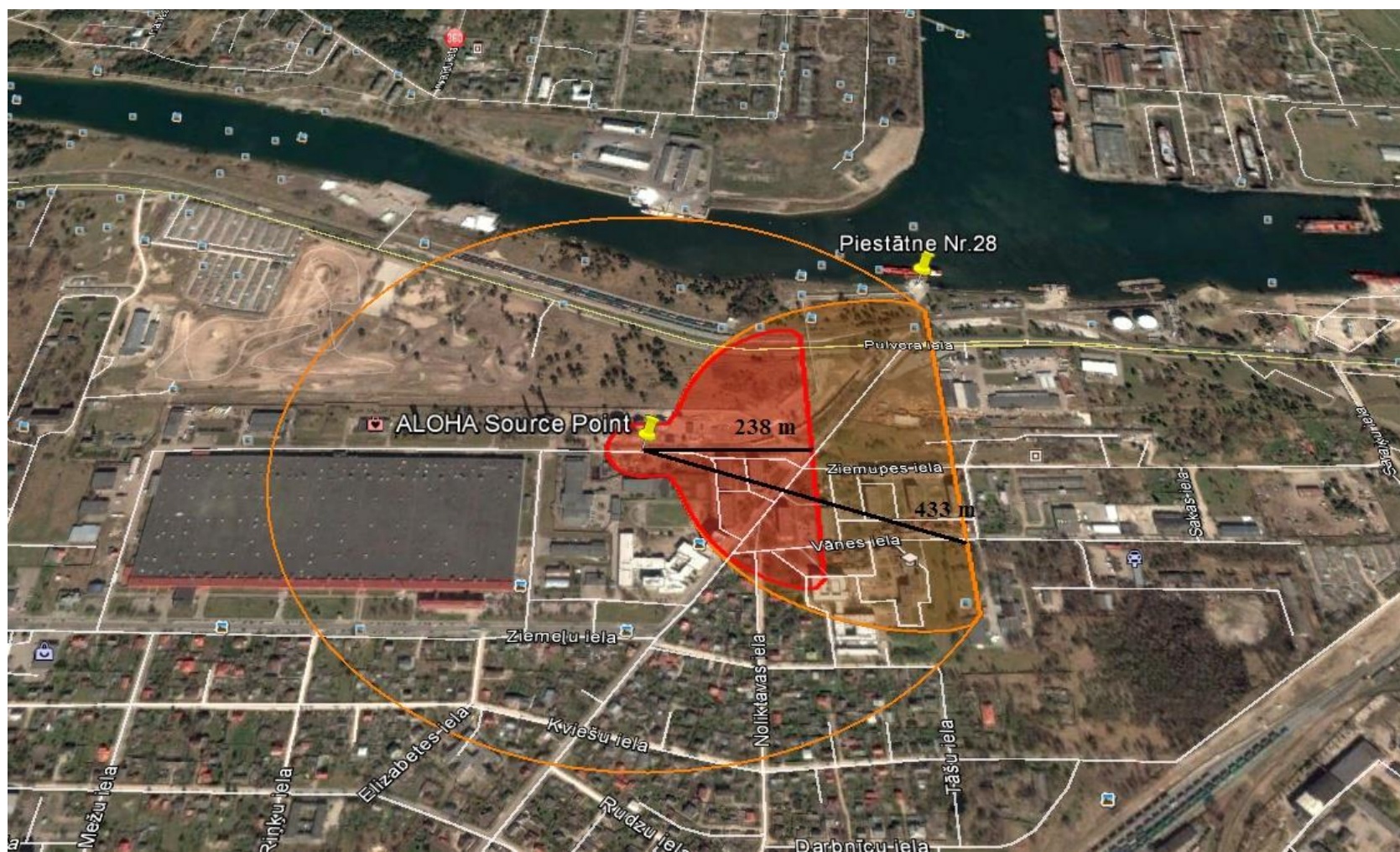
15.attēls. Vagoncisternas sabrukums dzelzceļa estakādē ar benzīna noplūdi un tvaiku toksisko koncentrāciju izplatību
