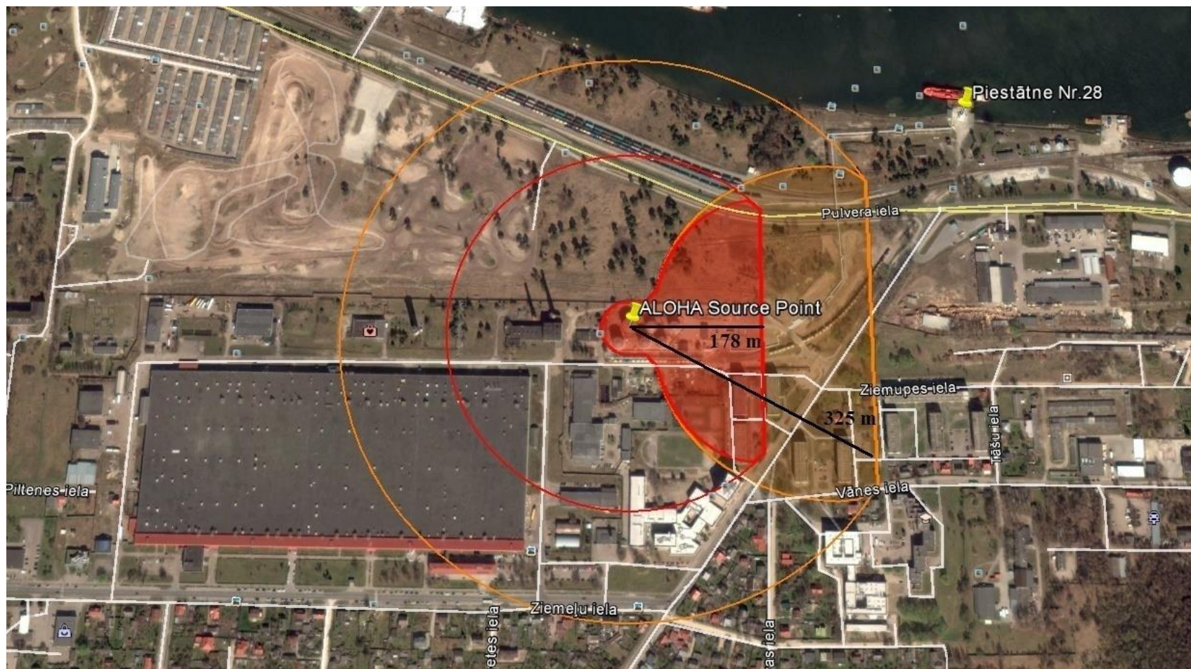
19.attēls. Rezervuāra (4900 m 3 ) sabrukums ar benzīna noplūdi un tvaiku toksisko koncentrāciju izplatību
