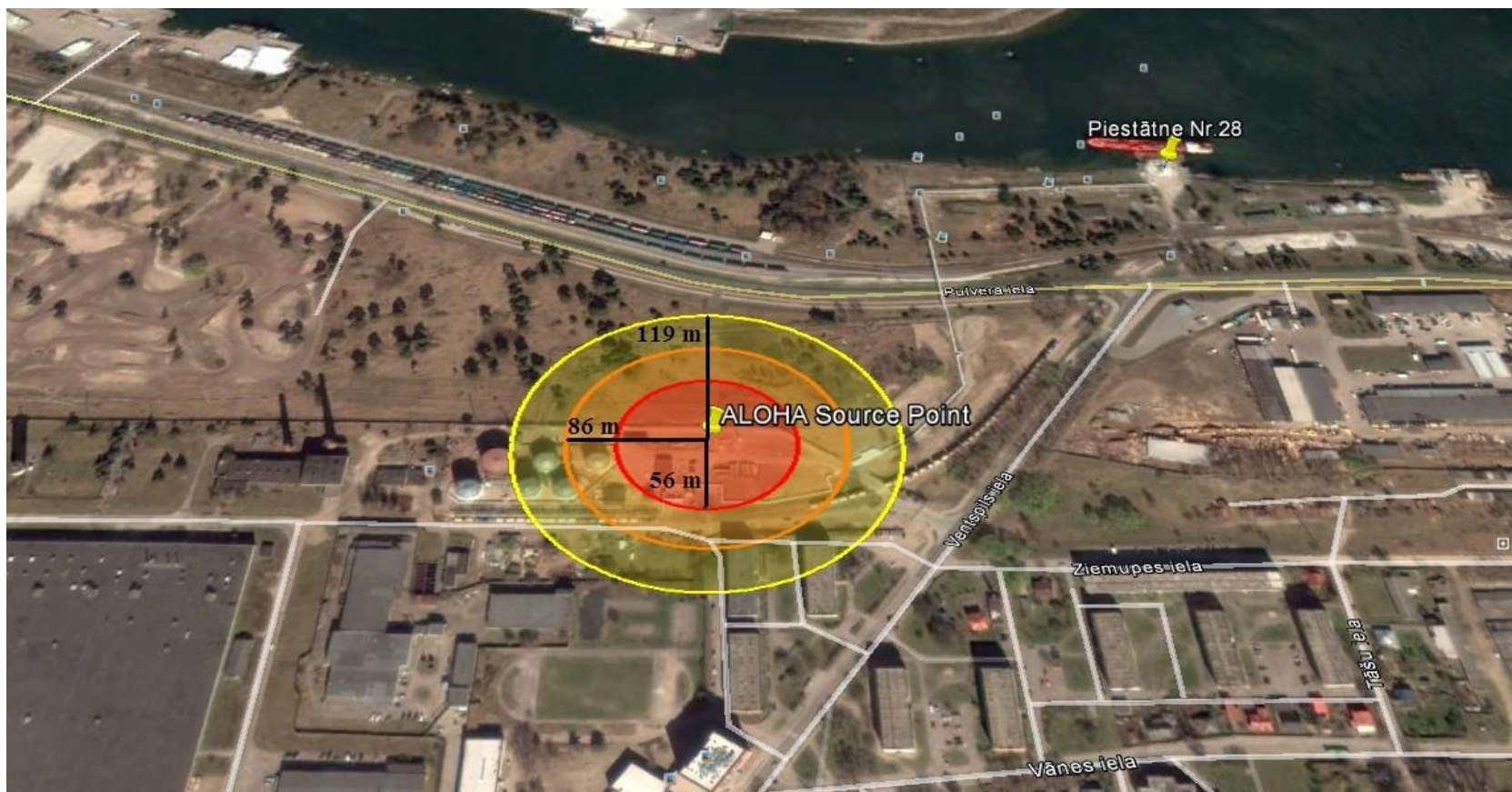
5. attēls. Flexi tanka/ISO konteineru (32 m 3 ) sabrukums autocisternu noliekšanas/uzpildes laukumā ar benzīna aizdegšanos
