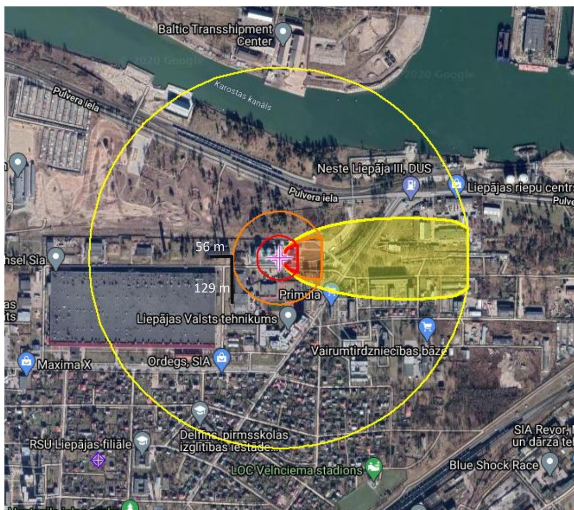
21. attēls. Tehnoloģiskā cauruļvada ( D=300 mm) plīsums benzola pārsūkņēšanas laikā uz virszemes rezervuāru parku ar benzola noplūdi un tvaiku toksisko koncentrāciju izplatību
