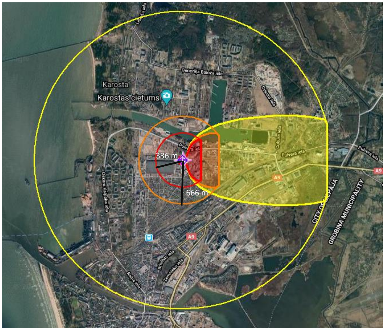
15. attēls. Vagoncisternas sabrukums dzelzceļa estakādē ar benzola noplūdi un tvaiku toksisko koncentrāciju izplatību
