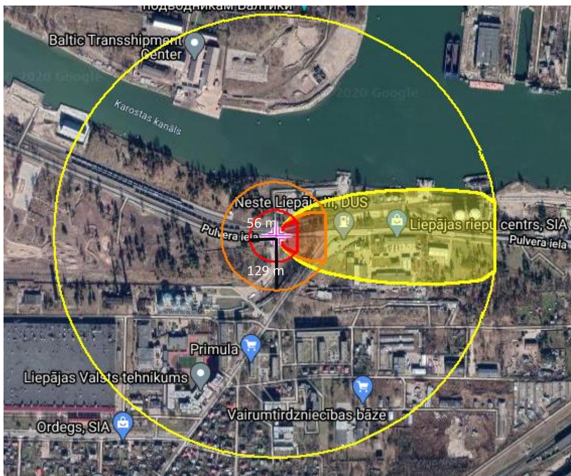
23. attēls. Tehnoloģiskā cauruļvada ( D=300 mm) plisums benzola pārsūkņēšanas laikā uz/no tankkuģi ar benzola noplūdi un tvaiku toksisko koncentrāciju izplatību
