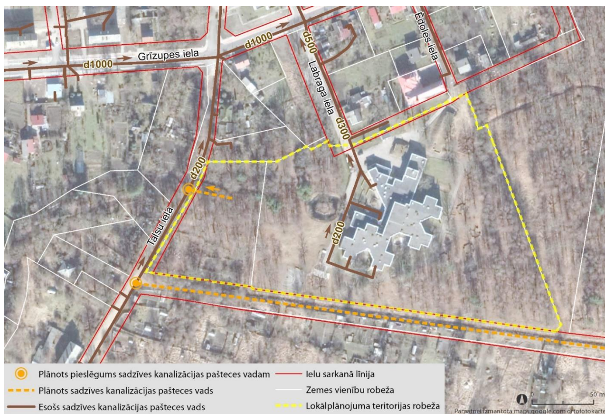
Attēls 40. Esošie un plānotie sadzīves kanalizācijas tīkli lokālplānojuma teritorijā un tās apkārtnē
