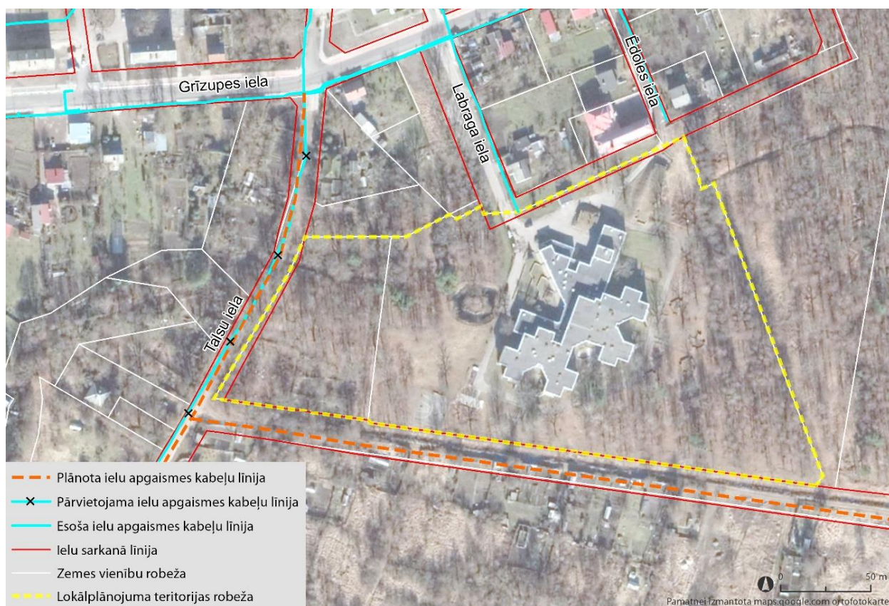
Attēls 39. Esošais un plānotais ielu apgaismojums lokālplānojuma teritorijas tuvumā
